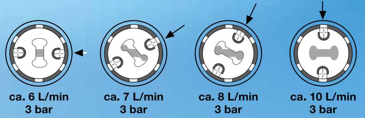
هذه المجموعة الاختيارية متوفرة مع خلطات أحواض، بديهات وبانيوهات ايديال ستاندر، لتتيح لكم فرصة التحكم في كمية المياه. الاستعمال مع خلطات الحوض والبديدة (شكل ١) يكون بلف الجزء البلاستيكية من درجة الصفر (شكل الفراشة) والتي تعطي أقصى كمية مياه الى تسعين درجة. (شكل مربع) لتعطي أدنى كمية مياه. للتركيب اختياريًا يتم فك فلتر الخلاط ويركب الجزء الأخضر والابيض للمنظم على الخلاط ثم يعاد فلتر الخلاط مرة أخرى.
